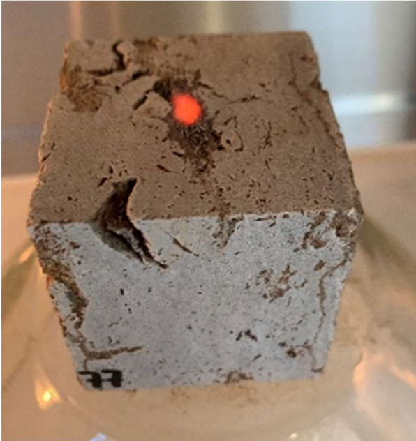
Bild 10: Beispiel Probekörper Eibelstädter Muschelkalk Glutstellen während der Bestrahlung
