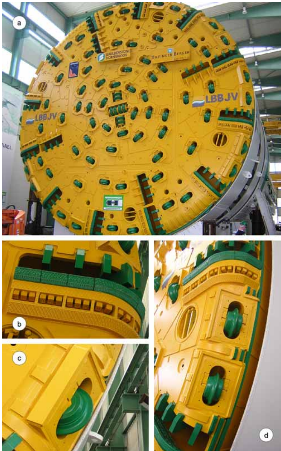
Abb. 2-5: (a) Bohrkopf einer TBM, (b) Räumerschlitze, (c) Kaliberdiske, (d) Kaliberdisken und Räumerschlitze
