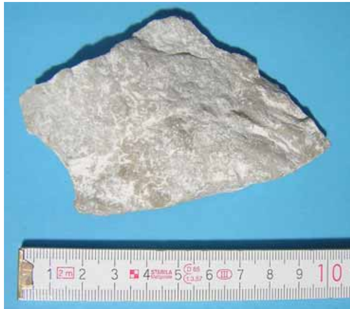
Abb. 3-8: Bohrchip aus Kalkstein, Nordtunnel bei Trient, Italien
