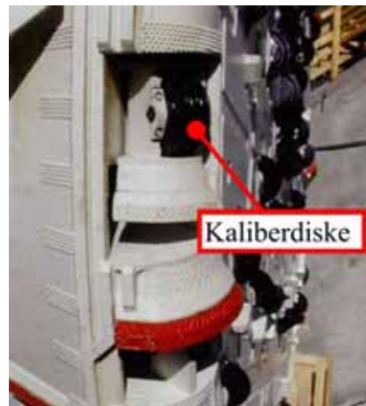
Abb. 2-7: Überschneidmeißel mit ausfahrbarer Räumerschaukel, (WOLF ET AL. [2003])
