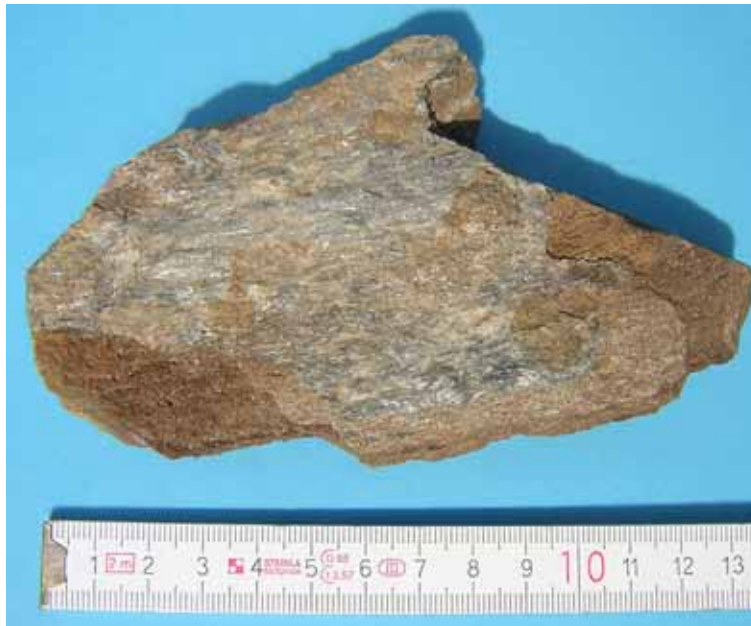
Abb. 3-7: Bohrchip aus Sandstein, Islisbergtunnel, Schweiz
